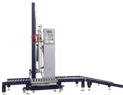
图 3.1.4-1 全自动灌装机设备示例图（红圈为集气联锁装置）
