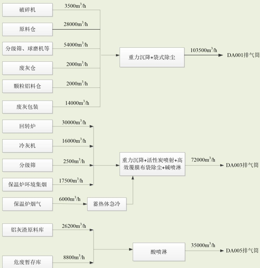
图 6.1-1 车间二废气产生节点及处理流程图
