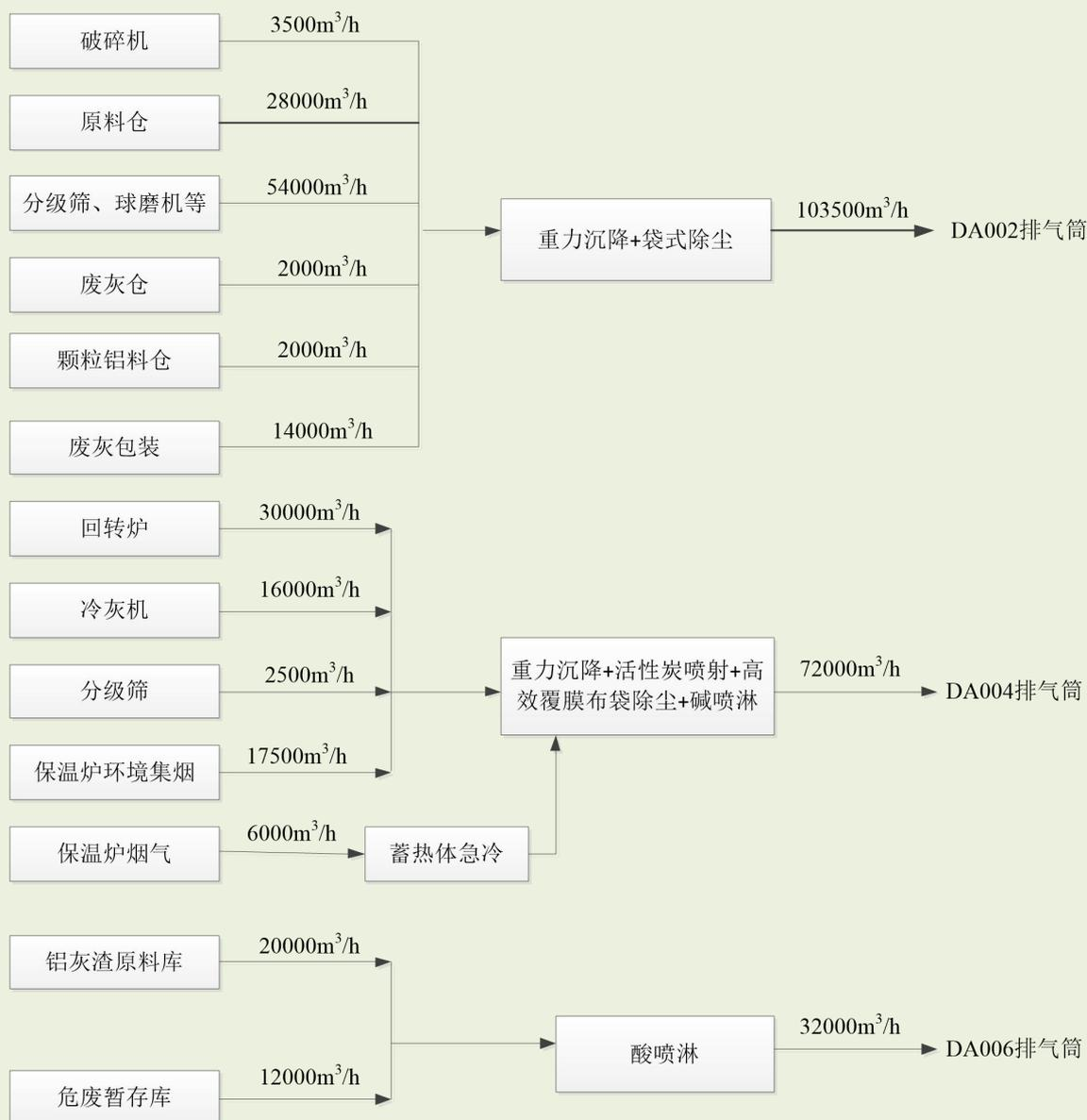
图 6.1-2 车间四废气产生节点及处理流程图
