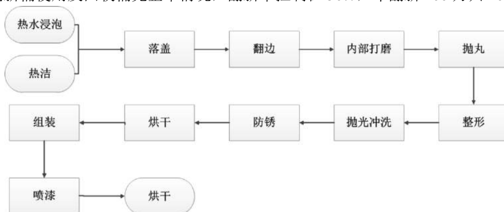
图 2.7-3 200L 可翻新废旧包装桶处置工艺流程框图
