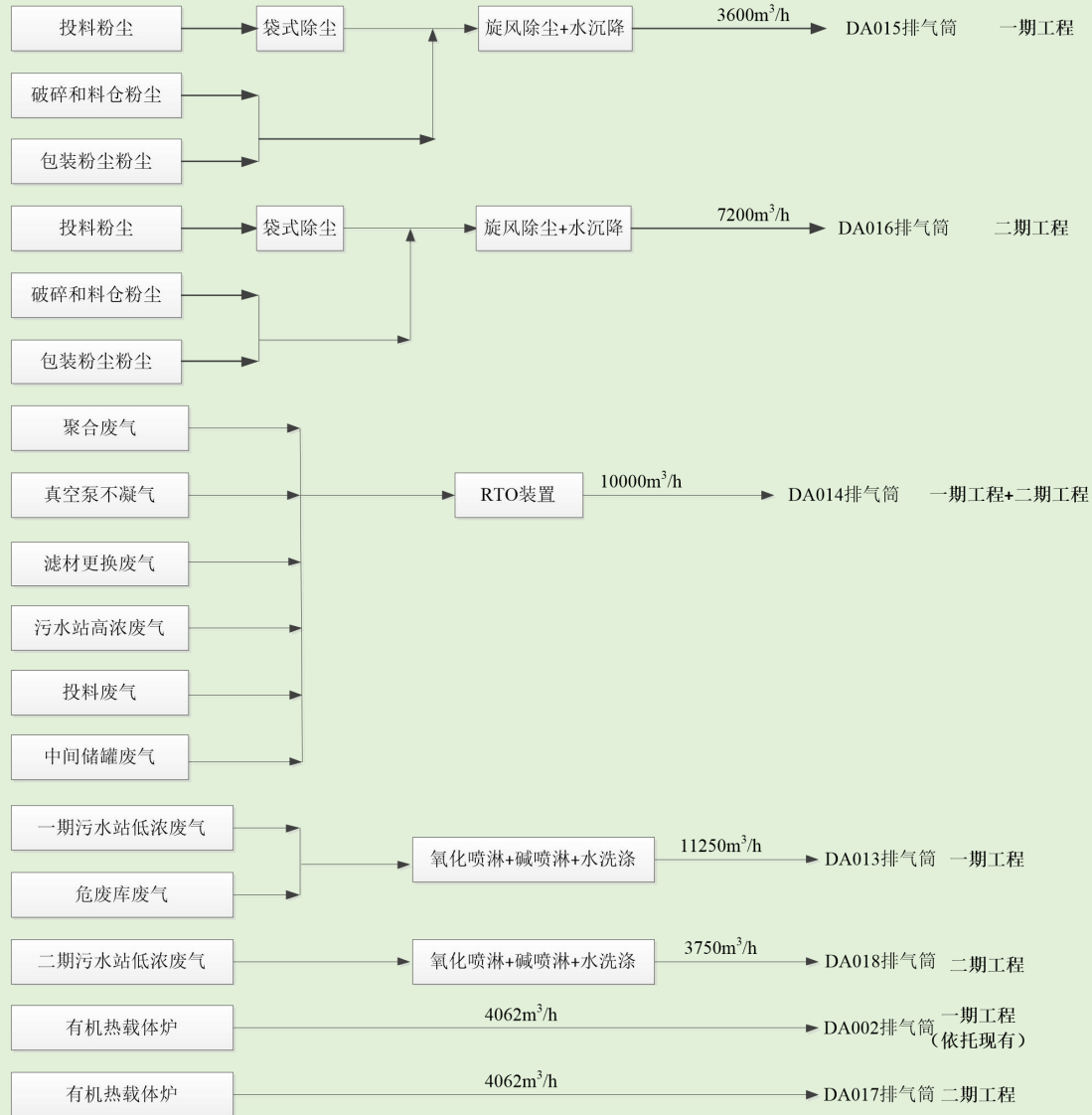
图 7.2-1 废气处理流程图
