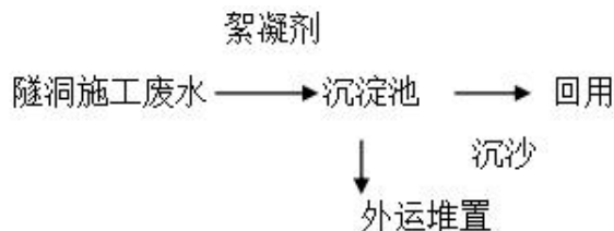
图 7.1.1-5 隧洞施工废水处理工艺流程示意图
