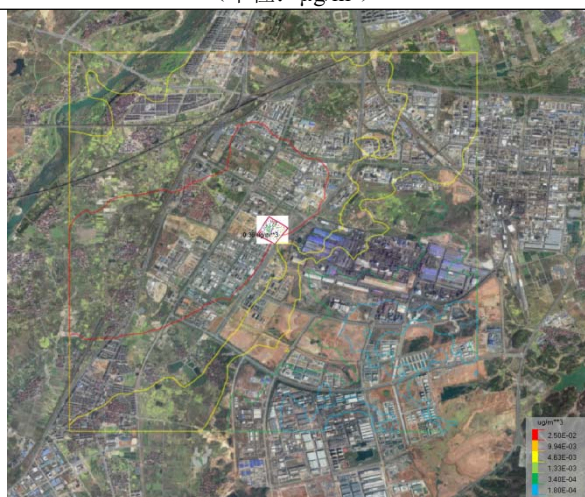
图 6.1-21 TSP 年均浓度等值线分布图 (单位: \mu\text{g}/\text{m}^3 )
