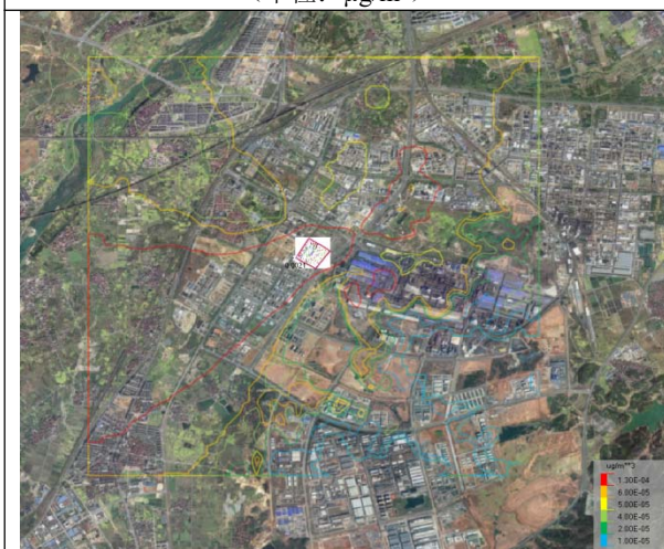
图 6.1-20 PM 2.5 年均浓度等值线分布图 (单位: \mu\text{g}/\text{m}^3 )
