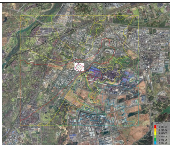
图 6.1-19 PM10 年均浓度等值线分布图 (单位: \mu\text{g}/\text{m}^3 )
