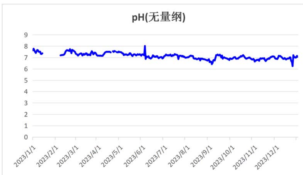
图 3.6-3 现有工程废水 pH 在线监测趋势图
