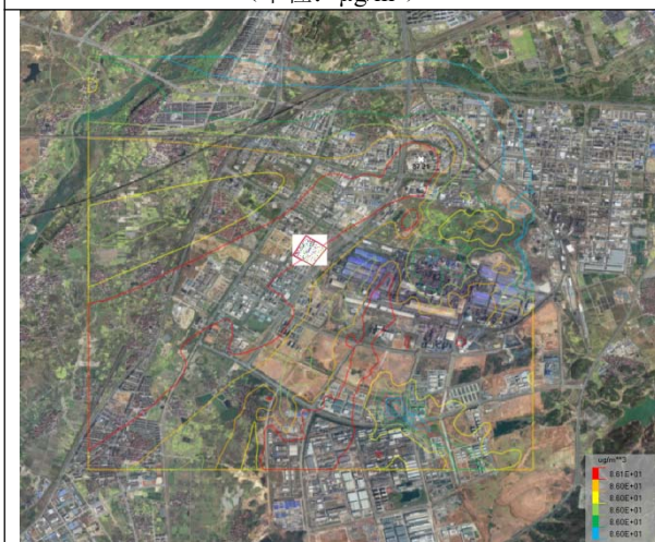
图 6.1-22 PM10 保证率日均浓度等值线分布图 (单位: \mu\text{g}/\text{m}^3 )
