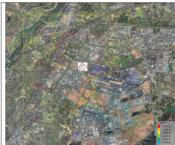
图 6.1-18 TSP 日均浓度等值线分布图 (单位: \mu\text{g}/\text{m}^3 )
