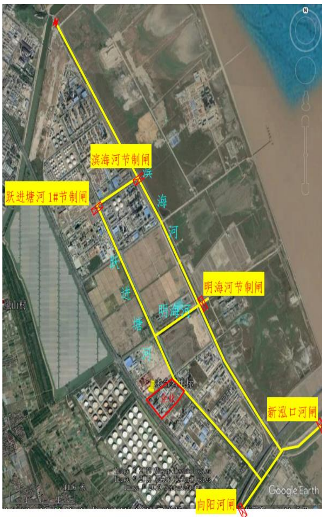
图 6.8-7 石化区防洪渠截断封堵设施示意图
