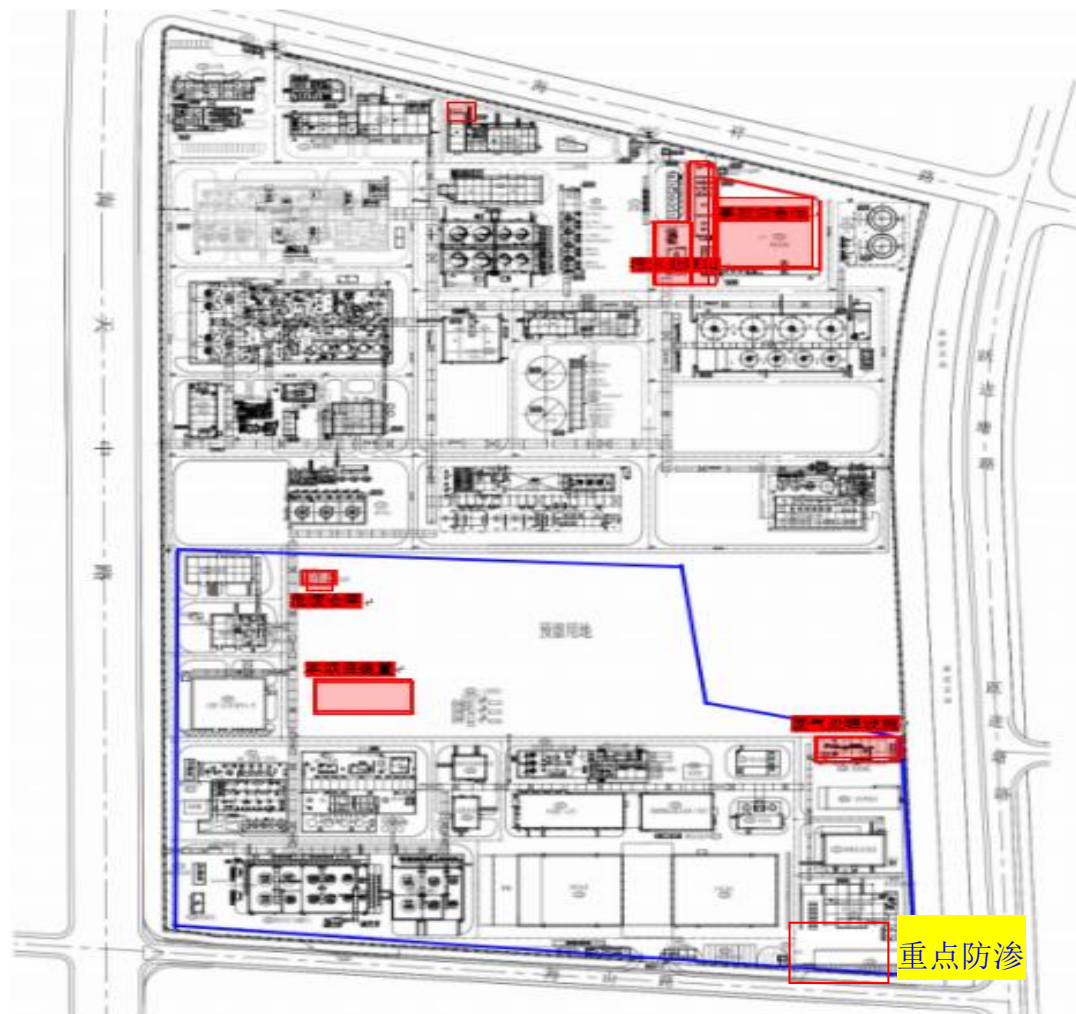
图 7.5-1 本项目地下水污染防治分区防渗区
